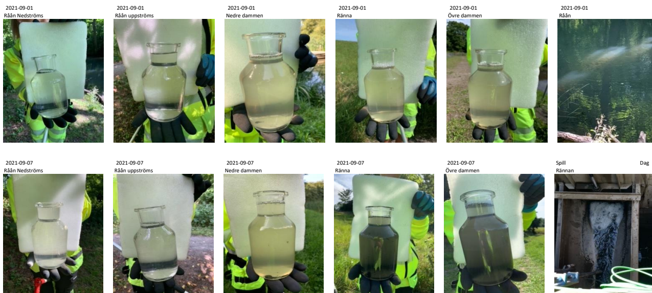
Figur 2. Exempel från NSVA:s fotodokumentation av dagvattenprov. Övre bildrad under normala förhållande den 1 september och nedre bildrad, den 7 september, med tydlig förorening i dagvattnet.
