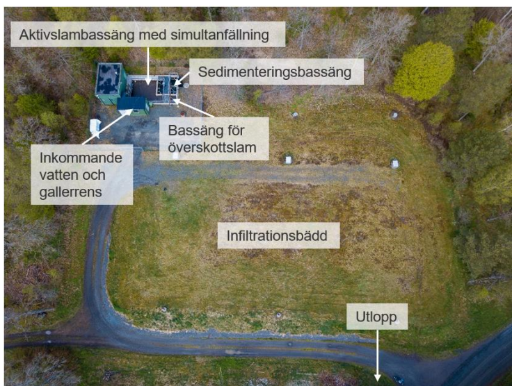
Figur 3. Oderlunga avloppsreningsverk och de olika reningsstegen.
