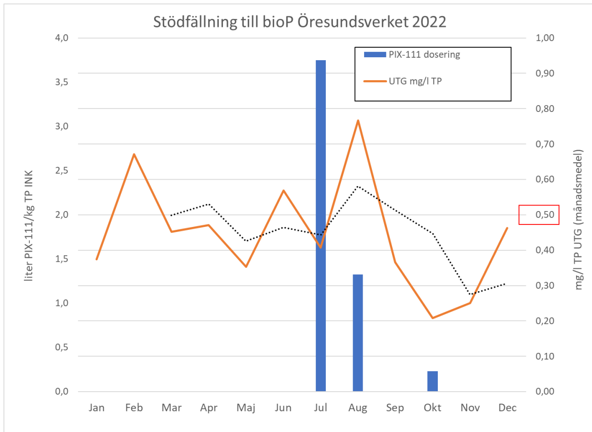
Figur 6. Utgående fosforutsläppshalter från Öresundsverket under 2022 (månadsmedel) och uppföljning av kemisk stödfällning till den biologiska fosforreningen. Den streckade linjen är tre månaders glidande medelvärde.
